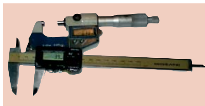
Standardní mikrometr a posuvné měřtko, "starý" design bez ochrany IP.
