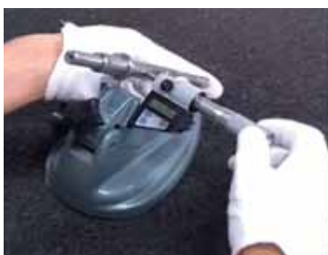
Měření průměru pomocí mikrometru nedokáže rozpoznat liché číslo podmínek kruhové charakteristiky a rozlišení je marginální.
